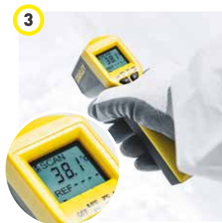
TEMPERATURA REGISTRATA SU TOP COAT: 38,1 °C
